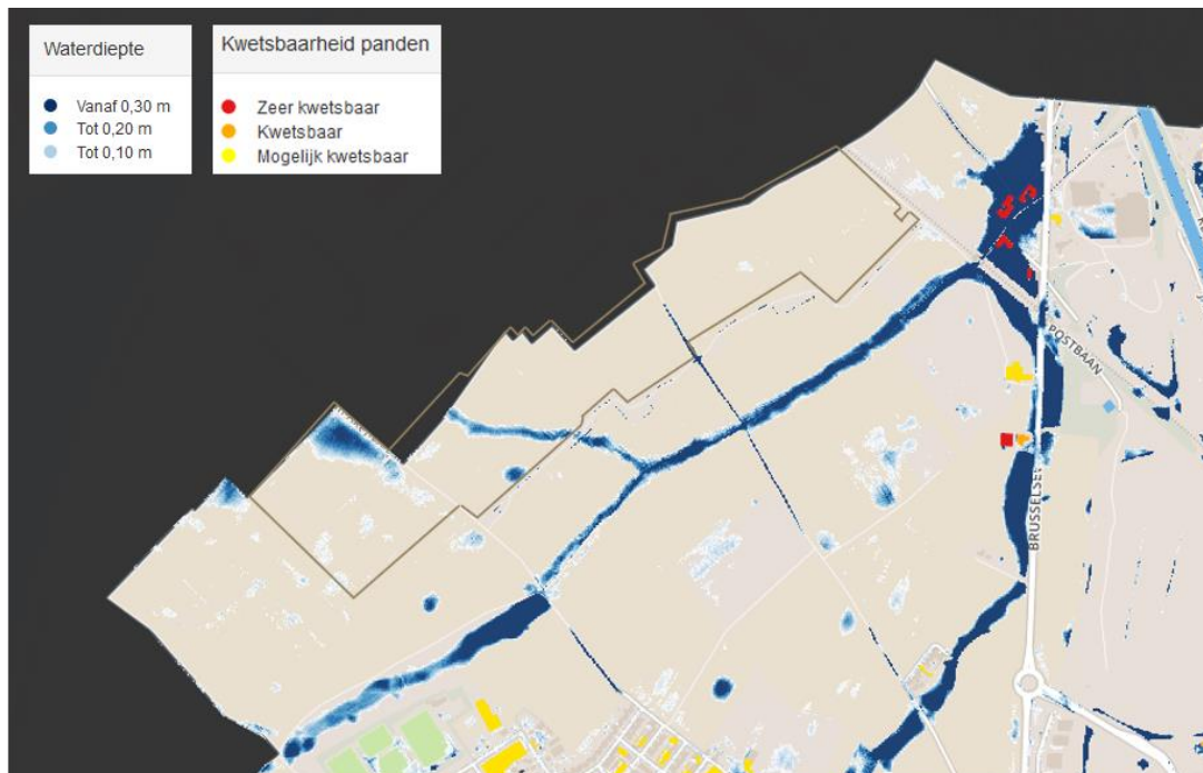
Figuur 7 Kwetsbare panden benedenstrooms van het plangebied bij extreme neerslag (T=100)
